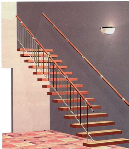
Figure 6.22 : Marches en console sur mur
