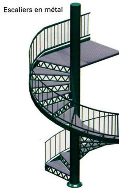
Figure 6.23 : Marches en console pour escalier hélicoïdal
