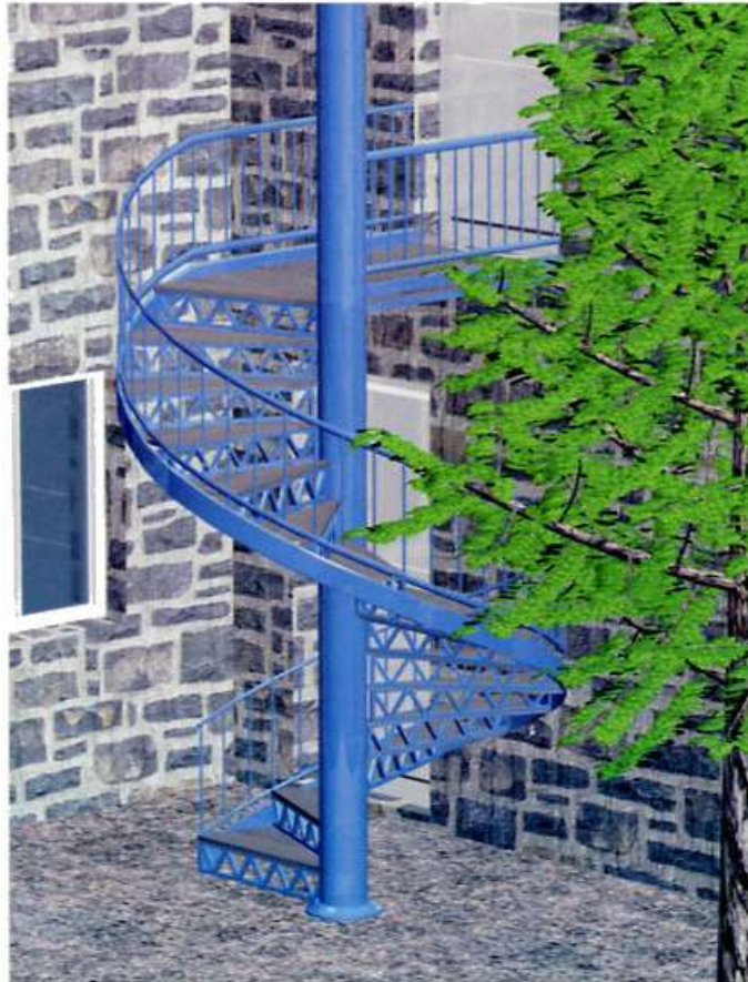
Figure 6.25 : Escalier extérieur métallique intégré au bâti
