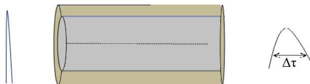
**Figure 8 :** Dispersion chromatique d'une fibre optique
