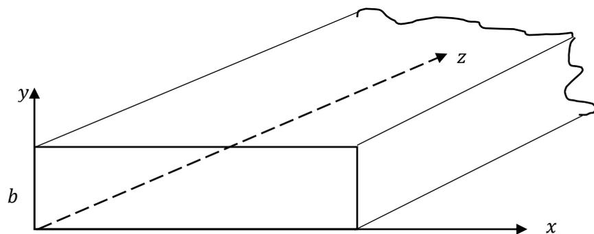
Figure 1 : Représentation d'un guide d'onde rectangulaire de longueur  $a$  sur l'axe  $x$  et de hauteur  $b$  sur l'axe  $y$
