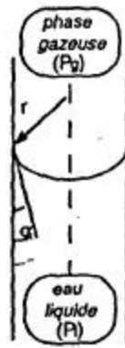
Fig 2.14 - Schématisation d'un ménisque dans un capillaire
