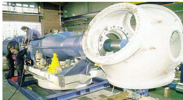
Figure N° 13: un moyeu lors de son assemblage avec l'arbre.
