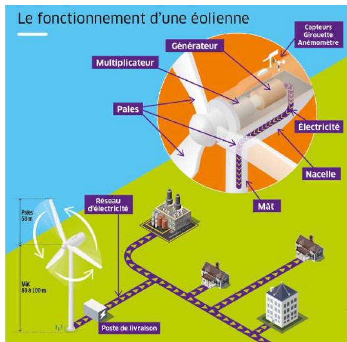
Figure N° 18: Fonctionnement d'une centrale éolienne [16].
