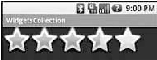
Figure – Exemple d'un Rating Bar
