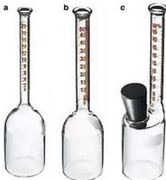
Figure 06 : Bouteilles de Babcock pour les lipides du lait (a), de la crème (b) et du fromage (c).
