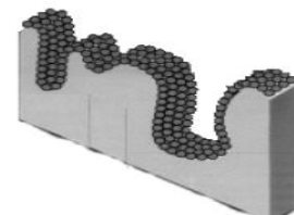
Figure IV.8: Représentation schématique du recouvrement monomoléculaire d'une surface
