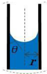
Figure V.5 : Ménisque concave de forme quelconque dans un capillaire cylindrique
