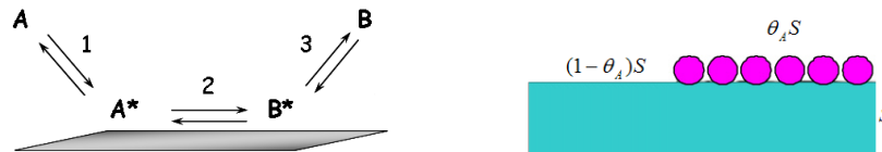
Figure VII.7 : Adsorption d'un composé gazeux A sur la surface d'un catalyseur
