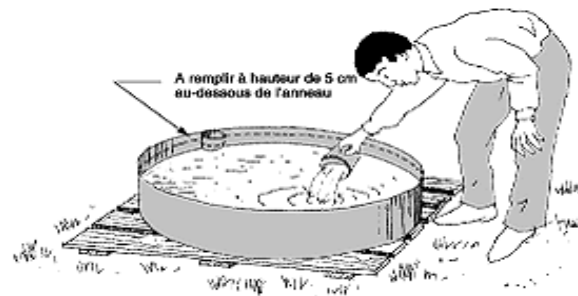
Figure n° 3 :L'évaporimètre, ou bac évaporatoire, standard de classe A, mis au point par le US Weather Bureau.
