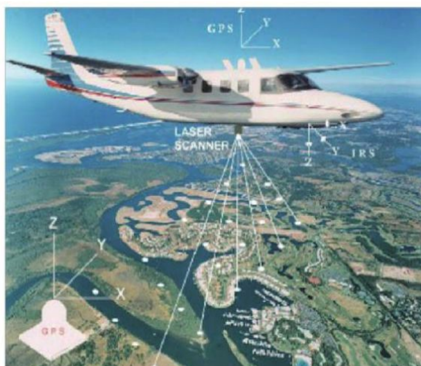
Figure VI.11 : Principe de l'acquisition de l'altimétrie par balayage laser (Caloz et Collet, 2011).
